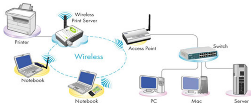
Gambar 1. Topologi jaringan wireless mode infrastruktur
